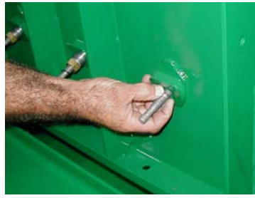
Step 2 - Install O-ring on bolt.
