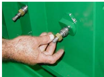
Step 8 - Install nut on draw bolt.
