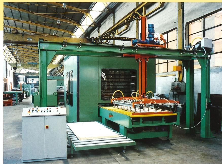
Gruppo di scarico ed impilaggio dei pannelli pressati composto da una rulliera motorizzata a rulli inclinati per lo scarico e l'allineamento, un dispositivo a ventosa per prelievo e traslazione ed una rulliera di impilaggio e successivo trasferimento delle pile.
