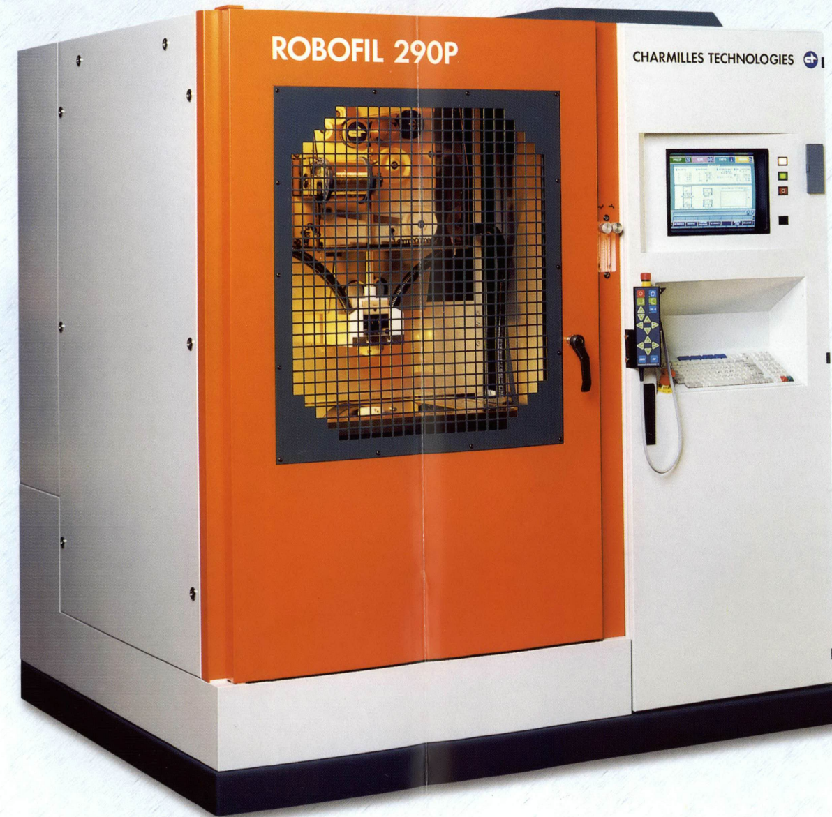
Les courses X-U de 400 mm et Y-V de 250 mm permettent d'obtenir des angles de dépouille exceptionnels.
