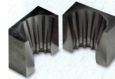
Bei Koniken zwischen 10° und 20° gewährleistet der Taper-Expert Gürtellinien im Bereich von 5µm. Dies ist ein bedeutender Faktor, wenn es darum geht, ein perfektes Strangpressprofil zu fertigen.
