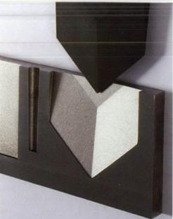
PCE, l'autoadaptation en continu du courant d'usinage garantit le respect de la géométrie de l'électrode et réduit considérablement le temps d'usinage lors de la plongée
