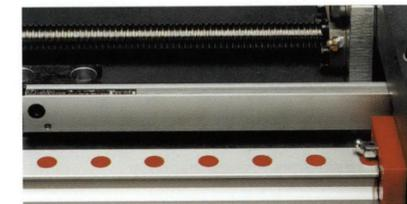
La commande numérique mesure la vraie position des guides fil au moyen de règles linéaires en verre de haute précision. Celles-ci permettent un contrôle direct du mouvement réel des coulisseaux X, Y, U, V ou Z. Equipée de systèmes performants, la machine est d'une précision constante et ne nécessite ni réglage ni calibrage périodique. Il n'y a aucun effet d'usure et la précision des déplacements sera la même pendant toute la durée de vie de la machine.
