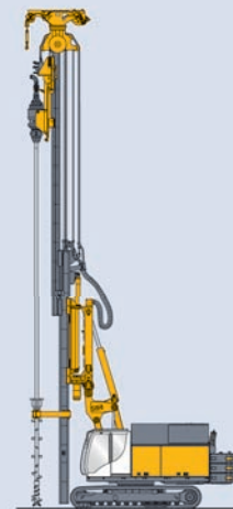
SCM Bodenmischen mit Einfachpaddel Single Column Mixing
