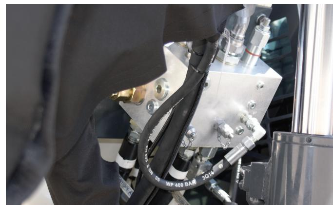
Placa amortiguador de cabezal incorporado sobre la misma cabeza.
