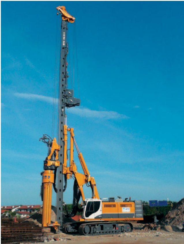
RG 25 S mit Doppelkopfbohrantrieb DKS 150/300 RG 25 S with double rotary drive DKS 150/300
