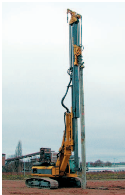
RG 18 T mit Tiefenrüttler TR 17 (Rüttelortbetonsäulen) RG 18 T with depth vibrator TR 17 (vibrated concrete columns)
