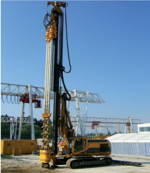
SMW-Ausrüstung mit Dreifachantrieb an RG 16 T SMW-attachment with triple drive on RG 16 T
