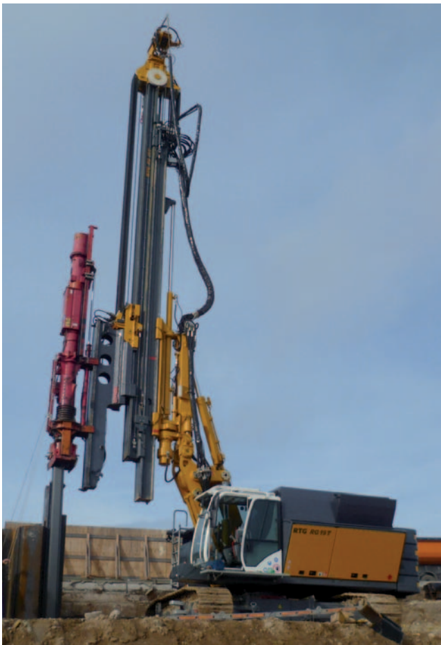
RG 19 T mit Dieselhammer zum Einbringen von Spundwänden RG 19 T with Diesel hammer for driving sheet piles www.pileco.com
