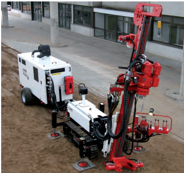
KR 702-2 mit Power Pack auf Rädern with power pack on wheels
