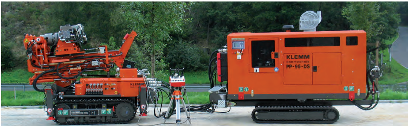
KR 702-2R mit Drehantrieb KH 20 und Power Pack PP-95DS auf Raupenfahrwerk with rotary head KH 20 and power pack PP-95DS on crawlers
