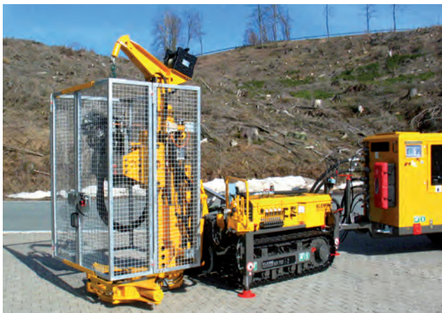
KR 702-2 mit Drehantrieb KH 20 und Sicherheitskäfig für Mikropfähle with rotary head KH 20 and safety cage for micro-piling
