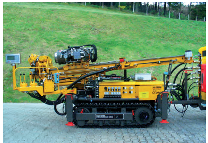
KR 702-2 mit Drehantrieb KH 9SK für HDI-Bohrungen with rotary head KH 9SK for HPI drilling
