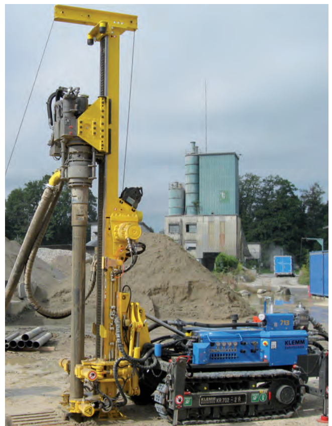
KR 702-2R mit Drehantrieb KH 20 für Geothermiebohrungen with rotary head KH20 for geothermal drilling applications
