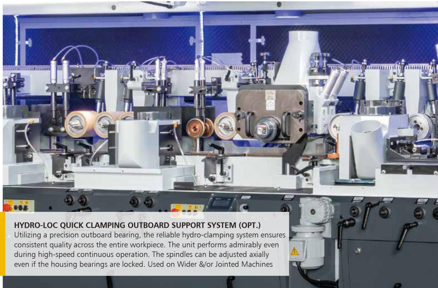
**HYDRO-LOC QUICK CLAMPING OUTBOARD SUPPORT SYSTEM (OPT.)**
