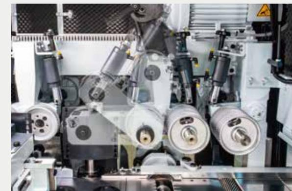
**LIFTABLE AUXILIARY FEED ROLLER**
