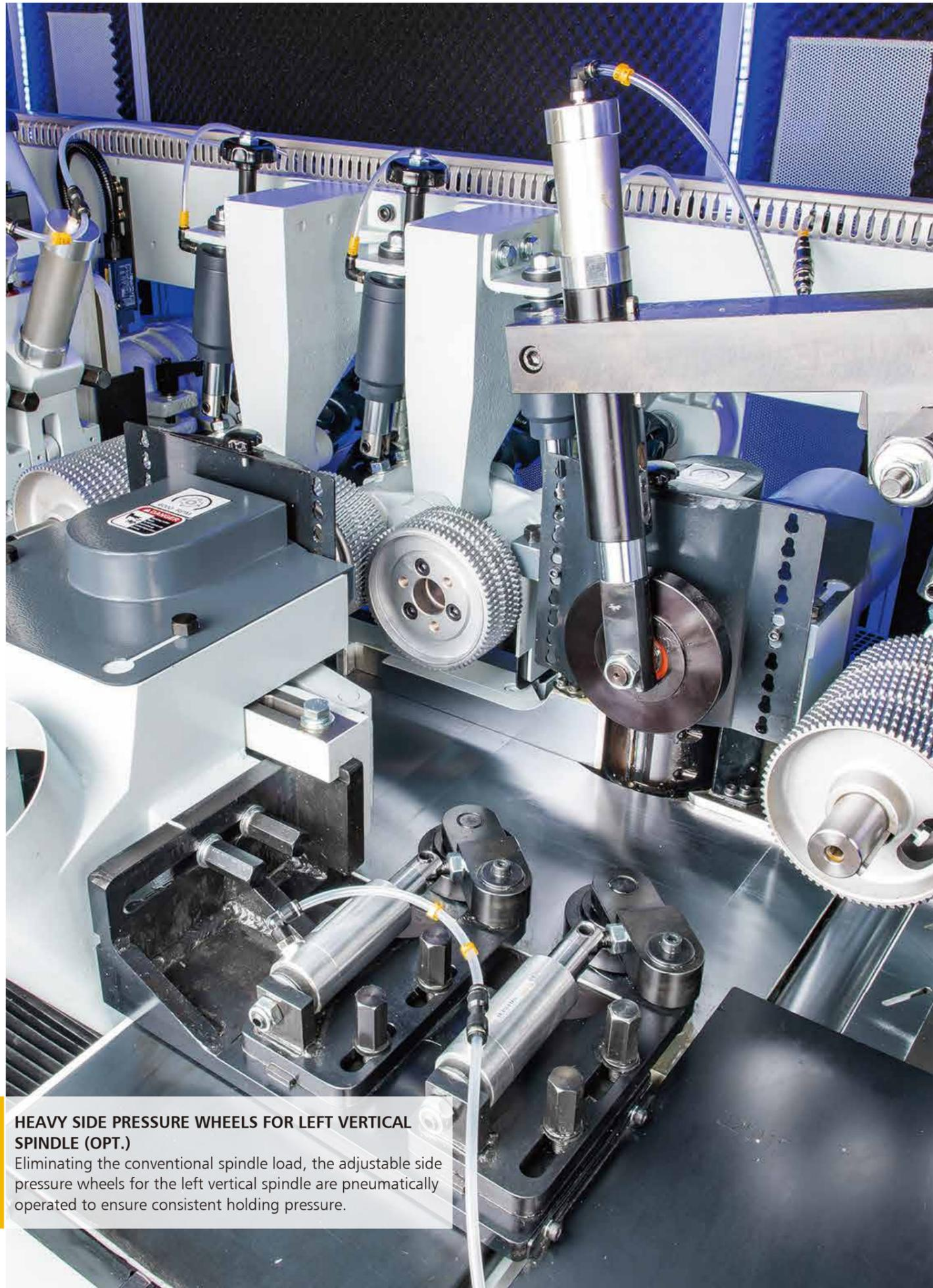
**HEAVY SIDE PRESSURE WHEELS FOR LEFT VERTICAL SPINDLE (OPT.)**
