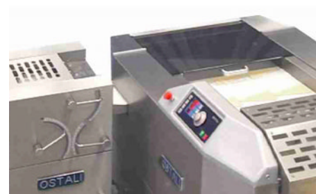
Il tappeto separatore temporizzato ottimizza il posizionamento dei triangoli di pasta
