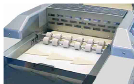
Il tappeto separatore temporizzato ottimizza il posizionamento dei triangoli di pasta
