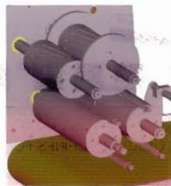
Quattro cilindri regolabili di laminazione Four adjustable laminating cylinders Quatre cylindres de laminage réglables Vier Walzzylinder regulierbaren Cuatro cilindros de laminación regulables
