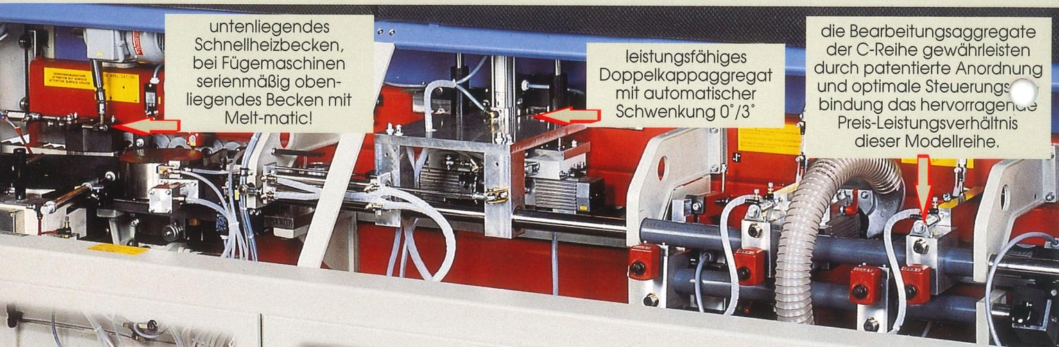
untenliegendes Schnellheizbecken, bei Fügemaschinen serienmäßig obenliegendes Becken mit Melt-matic!
