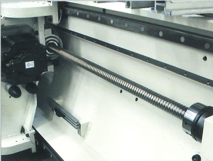
Die Bewegung der Achsen X, Y und Z erfolgt durch bürstenlose Motoren auf Kuglrücklaufschrauben; auf diese Art sind **Beschleunigungen und Abbremsen bis zu 5 m/sec<sup>2</sup>** mit absoluter Präzision bei der Positionierung möglich.
