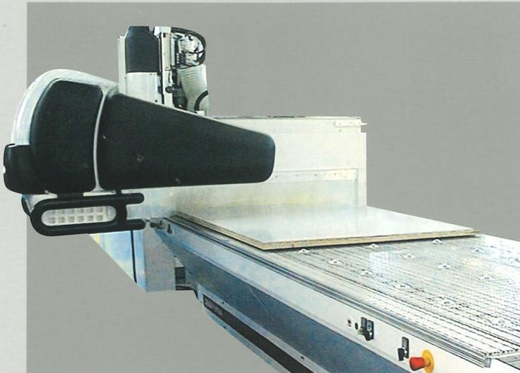
**Danke der Aluminium Bearbeitungstisch (mit Niederdruckung Blokierung) ist es möglich "nesting" Bearbeitungen zu machen;** es ist auch möglich alle Stücke für eine bestimmte Manufakturware (Küche, Schrank, Schreibtisch oder andere) machen, mit der optimierung vom Gebrauch von ein oder mehr Werkstückplatte wie MDF, Sperrspanplatte, Mehrschichtigplatte, usw.
