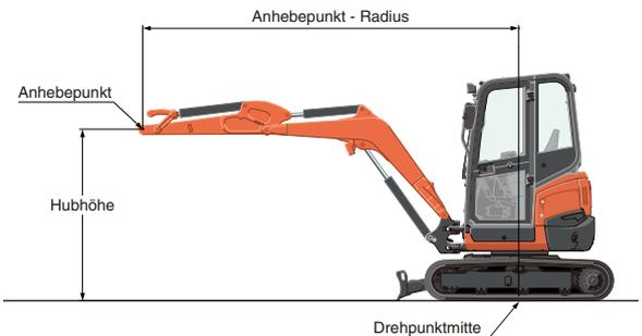
\* Die technischen Daten über den Arbeitsbereich der Maschine wurden mit dem Kubota Standard – Tieflöffel ermittelt, ohne Schnellwechseleinrichtung.
