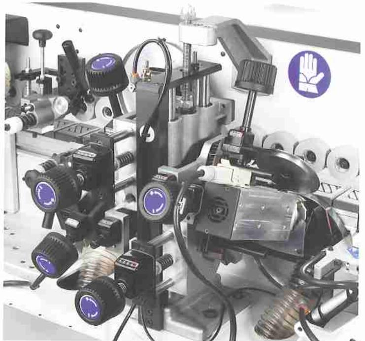
**Schwenkbares Bündigfräsaggregat RI-500**
