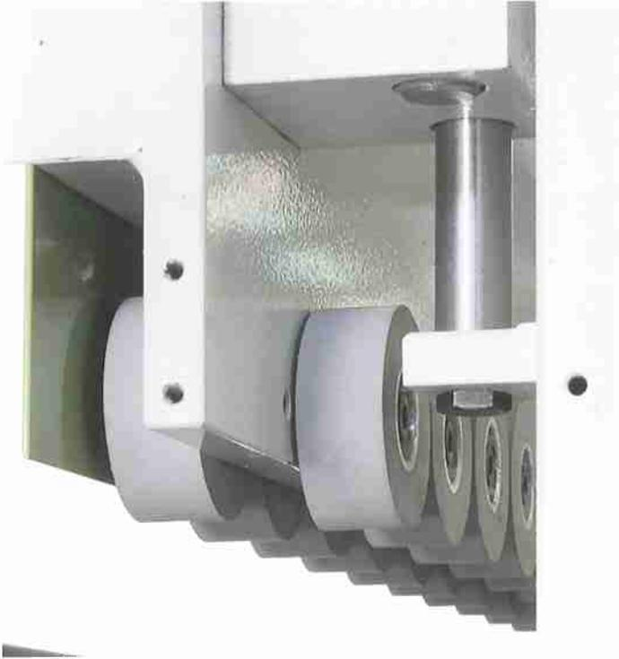
Der Oberdruck mit parallel versetzten kugelgelagerter Gummirollen sichert optimalen Halt des Werkstücks und ermöglicht die Bearbeitung von kleinen Teilen.
