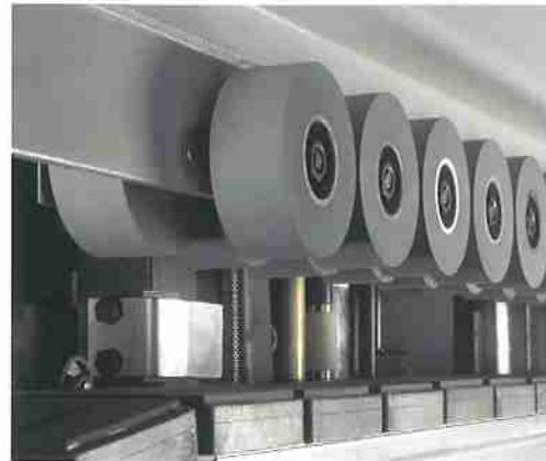
Pressore superiore con doppia fila di ruotini. Top pressure beam with two rows of pressing rollers.
