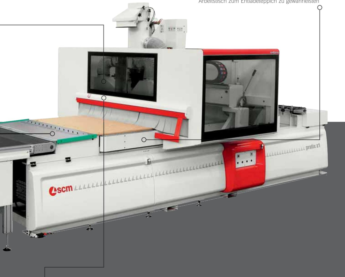
**Schieber für den Plattenausschub mit Blasdüsensystem**
