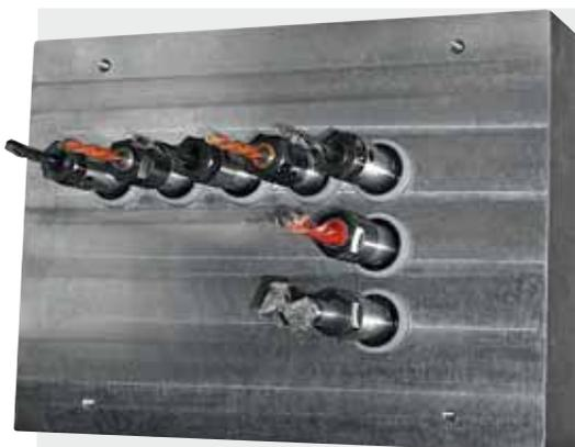
**Bohraggregate mit 7 Vertikalspindeln**
