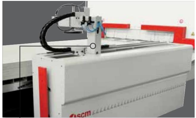
**Ausrichter am Werkstückeinlauf**
