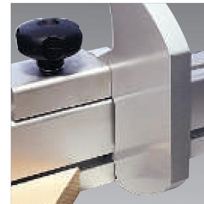
Der Ablänganschlagbacken wurde so konstruiert, dass eine kleine „Nase“ in die dafür vorgesehene Nut am Ablänganschlaglineal eingreift. Daher lassen sich schon auf Gehrung geschnittene spitze Winkel exakt am Anschlagbacken anlegen.
