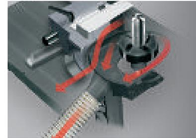
Die duale Fräsabsaugung aus dem Fräsansschlag und dem Spänefangbehälter unter dem Frästisch sorgt für eine saubere Maschine und gute Arbeitsergebnisse.
