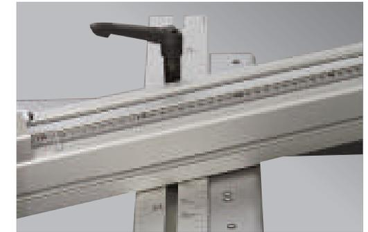
Mit dem Gradraster-Index-System am Auslegertisch stehen Ihnen in 5°-Schritten, aber auch bei 22,5° Rasterbohrungen zur Verfügung, die Sie mit Hilfe des Index-Rasterbolzens am Teleskopanschlag frei zwischen +45° und -45° wählen können.
