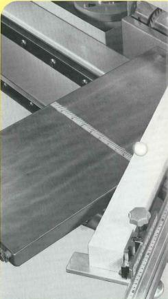
Der Aluminium-Längenanschlag is Fenstern eingestellt. Die Abbildung druckapparat und die zusätzliche V anschlag. Die Winkelverlängerung ist abnehmbar. Die Befehlsgeräte befinden sich im griffgünstigen Gehäuse über der Maschine. Sie werden vom Arbeitsplatz aus betätigt.
