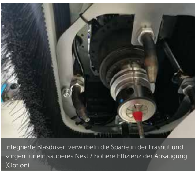
Leistungsstarke, bewährte 12 kW Hauptspindel, HSK-63F
