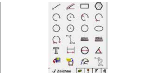
2D CAD Funktionen (Bögen, Doppelbögen, Geraden, Rechtecke, Quadrate, Ellipsen, Kreise, regelmäßige Polygone, u.v.m.)
