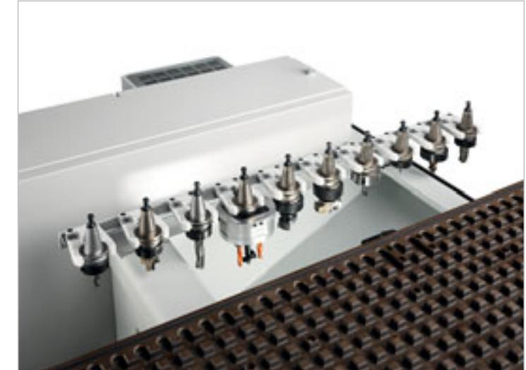
Magazzino laterale a 10 posizioni per utensili ed aggregati con diametro fino a 190 mm.
