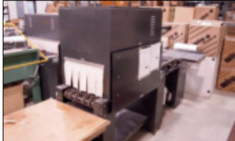
EASTELEY 16" SHRINK WRAP PACKAGING MACHINE W/HEAT TUNNEL
