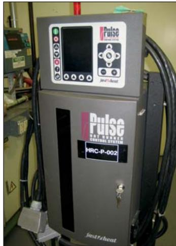
FAST HEAT PULSE DIGITAL HOT RUNNER CONTROLLER
