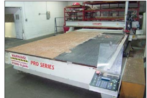
AUTOMATION MULTICAM PRO SERIES ROUTER
