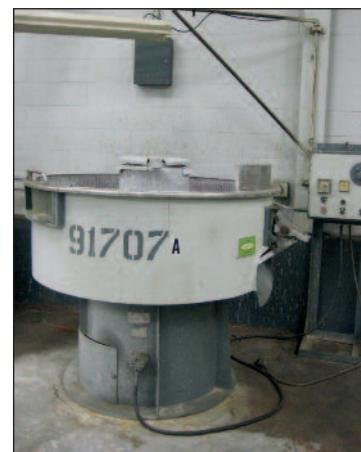
SWECO VIBRATORY FINISHING MILL
