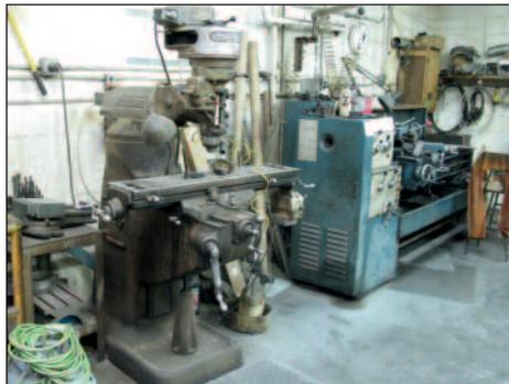
BRIDGEPORT MILL & ENCO LATHE
