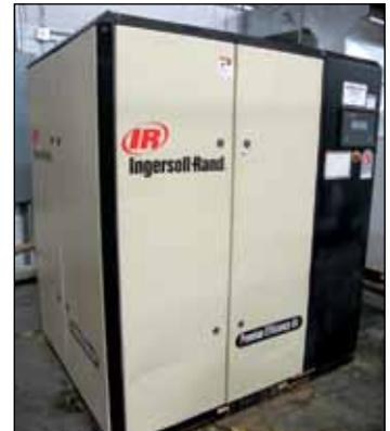
INGERSOLL RAND 60 HP ROTARY SCREW AIR COMPRESSOR MODEL SSR-EP60
