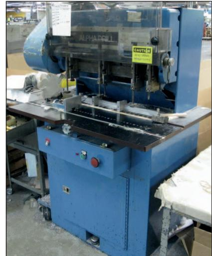
ALPHA 5-SPINDLE HYDRAULIC PAPER DRILL
