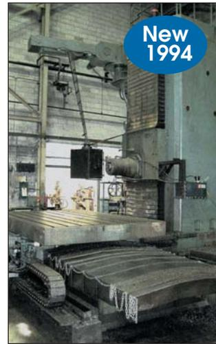
TITAN CNC HORIZONTAL BORING MILL MODEL #AF-125 4.9" SPINDLE
