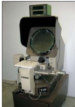
MITUTOYO 14" OPTICAL COMPARATOR MDL. PH-350
