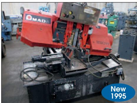
AMADA HORIZONTAL BAND SAW MODEL HFA250W
