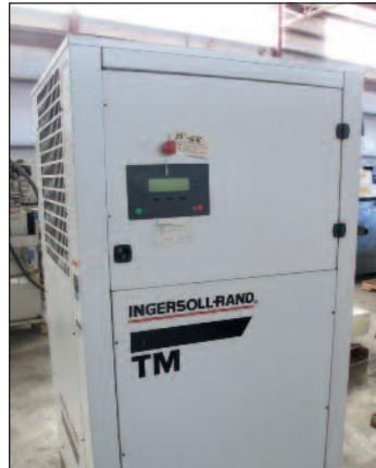
INGERSOLL RAND COMPRESSED AIR DRYER MODEL TM600-T
