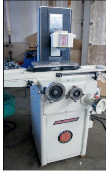
REID-ROLLERWAY PRECISION SURFACE GRINDER MODEL 618HR
