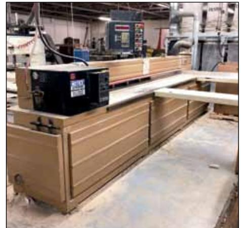
SCMI PANEL SAW MODEL Z32 W/ EPIC II CNC CONTROLS
