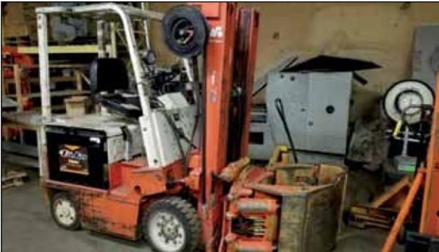
DATSUN ELECTRIC ROLL CLAMP FORKLIFT MODEL CYB02
