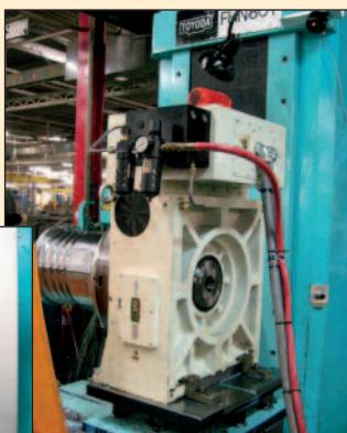
VIEW OF TSUDAKOMA A-AXIS OVER B-AXIS ROTARY TABLE
