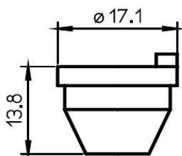
Keramikdel, Original dyshållare till skärhuvud KT M1.5" KN
