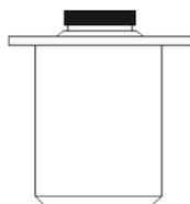
Dyshållare/nozzle holder passande Precitec mfl. (Planlaser, 2D) Längd 29mm
