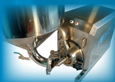
Das PVS-Micro-Cut Schneidsystem arbeitet absolut berührungs-frei, ohne metallischen Abrieb. Die Hochleistungsschneidwerkzeuge aus hochwertigem Chrom-Nickel Stahl sind mit Spezial-Schneidplatten bestückt und ermöglichen eine Standzeit von ca. 800 Tonnen.
