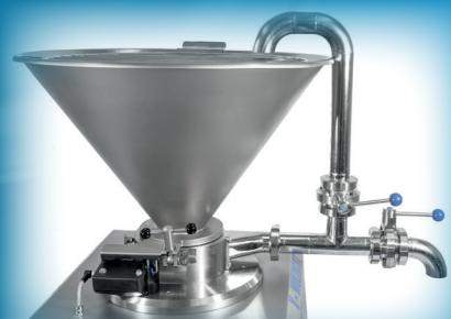
Das PVS-Micro-Cut Schneidsystem arbeitet absolut berührungs-frei, ohne metallischen Abrieb, nach dem Rotor-Stator-Prinzip. Die Schneidwerkzeuge aus hochwertigem Chrom-Nickel Stahl sind für hohe Durchsatzleistung mit Spezial-Schneidplatten bestückt.
