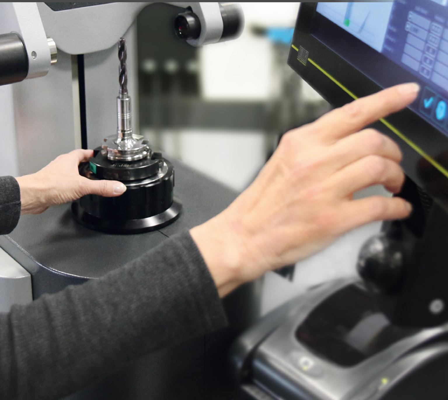
Die neue Bildverarbeitungstechnologie »pilot 1.0« ermöglicht alle Funktionen, die zum schnellen, einfachen Einstellen und Messen von Standardwerkzeugen benötigt werden. Zum Beispiel die „Automatische Schneidenform- und Messbereichserkennung“, das Navigationssystem
