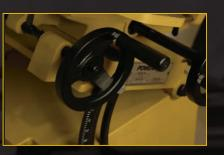
GAS CYLINDER CONTROLLED RACK-AND-PINION
