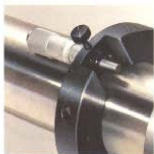
6 Verstellbarer Längsanschlag mit Feineinstellung durch Meßschraube
