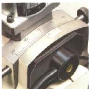
2 Tangentiale Schnell- und Feinverstellung \pm 20^\circ , unabhängig von der Dralleinstellung
