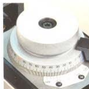
1 Skalenring zur stufenlosen Drall-einstellung
