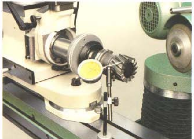
Meßuhr mit Halter zum Einstellen des Drallwinkels
