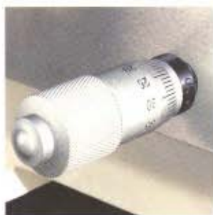
7 Quersupport mit Feineinstellung durch Meßschraube
