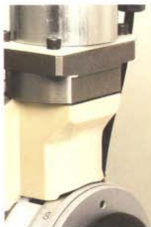
3 Indexierung der Teilscheibe – elektromagnetisch betätigt
