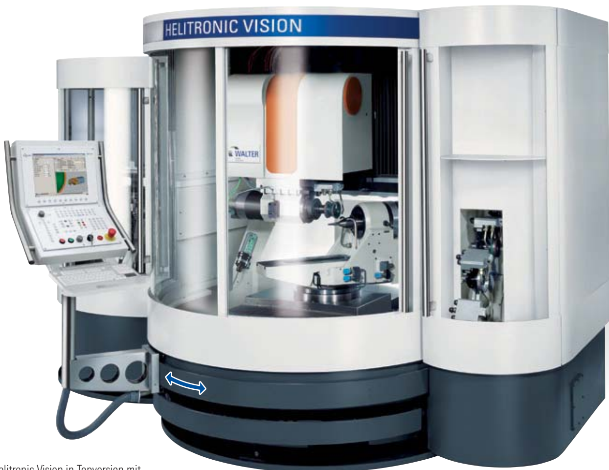
Helitronic Vision in Topversion mit integriertem Schleifscheibenwechsler rechts
