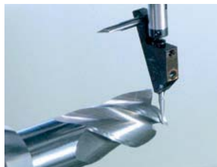
IMS – Messung Durchmesser.
