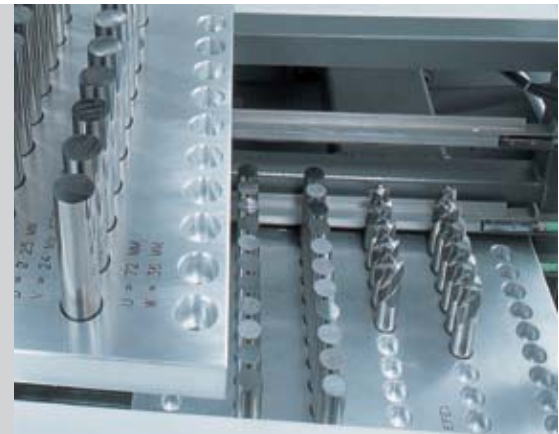
Die Paletten können auch mit Werkzeugen unterschiedlicher Länge bestückt werden.
