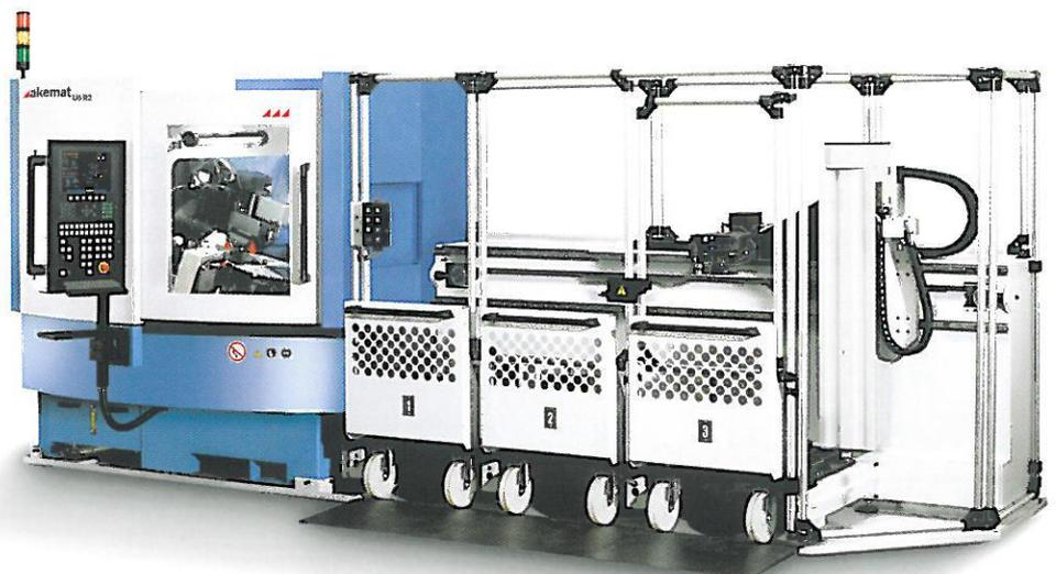
Das akemat Service Center mit drei Beladewagen für die vollautomatische Bearbeitung von ca. 100 Sägeblättern
