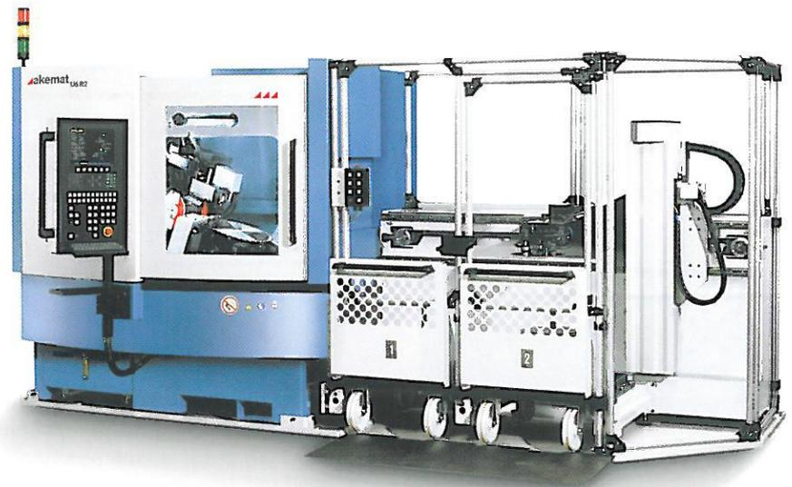
Das akemat Service Center mit zwei Beladewagen für die vollautomatische Bearbeitung von ca. 50 Sägeblättern
