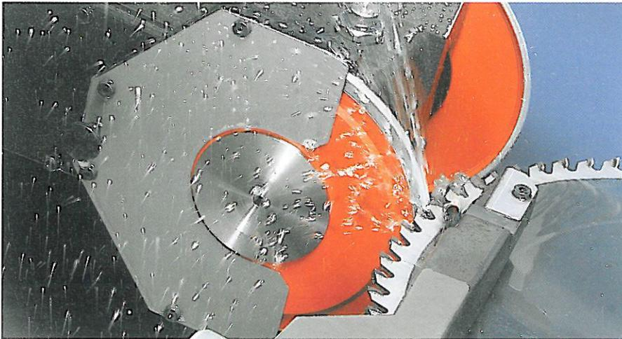
Sowohl mit Emulsion als auch mit Öl als Kühlmittel sind hervorragende Schleifleistungen garantiert
