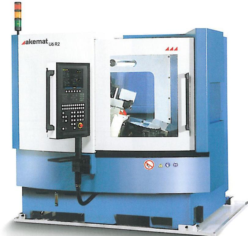
Die Vorteile der akemat U6 R2 Schärfmaschine können auch in der Ausführung als Stand-alone Maschine genutzt werden. Eine spätere Anbindung an die automatische Beladeeinrichtung ist jederzeit möglich und erst dann besonders wirtschaftlich.
