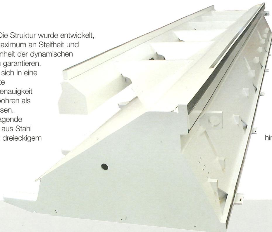
Querschnitt stellt eine **hochfeste und ausgewogene Basis** für den bewegliche Maschinenträger dar. Die Verrippung und die weite Führungsbasis wurden entwickelt und hergestellt, um der Maschine unter jeder Arbeitsbedingung Stabilität und Präzision über die Zeit hinweg zu garantieren.
