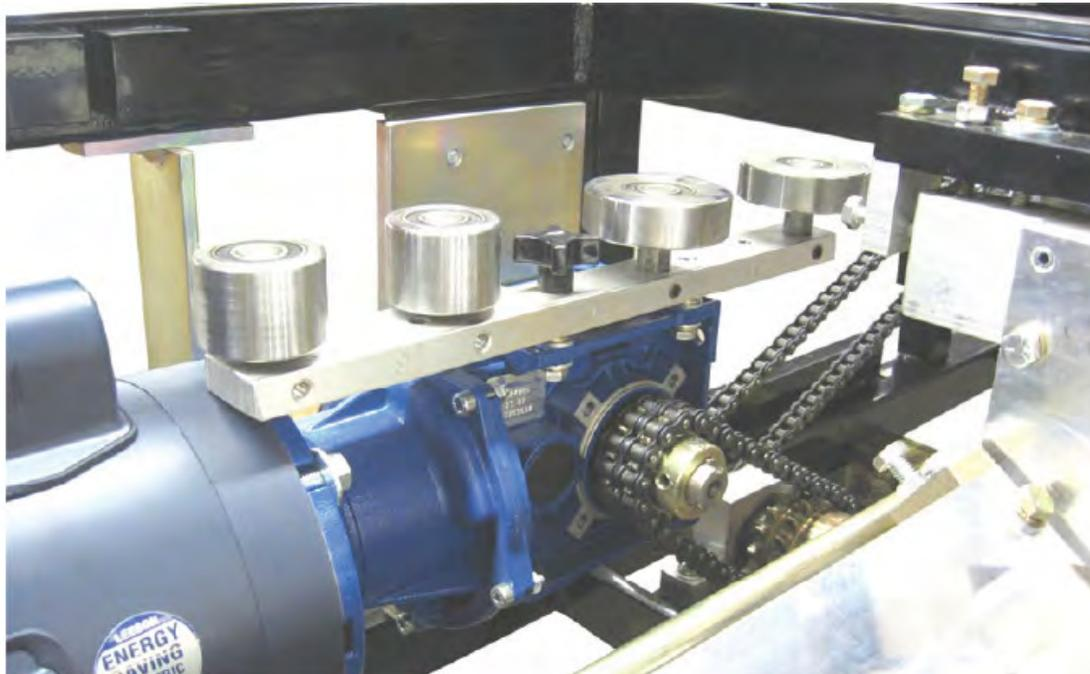
**Figura 64: Almacenamiento de los rodillos sin usar en el interior de la caja**
