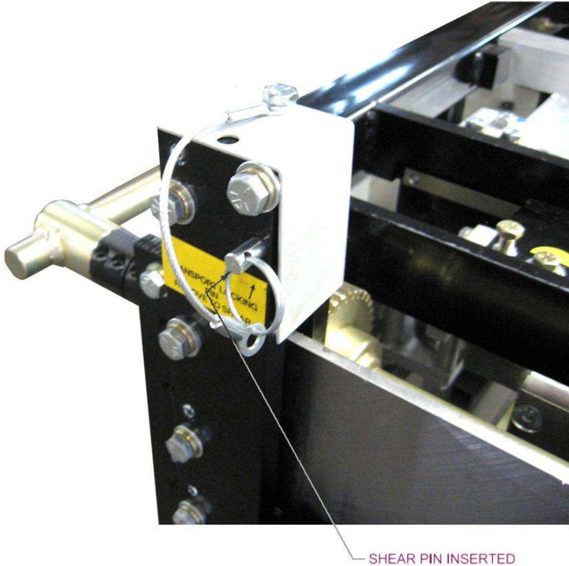
**Figure 43: Shear Pin**
