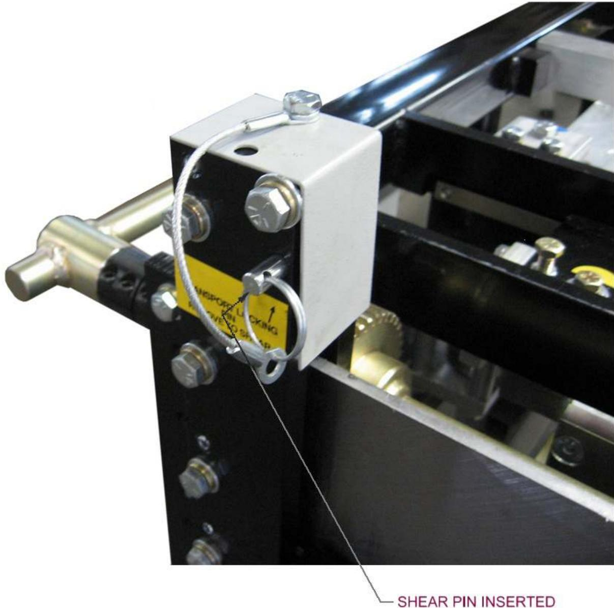
**Figure 59: Shear Pin**
