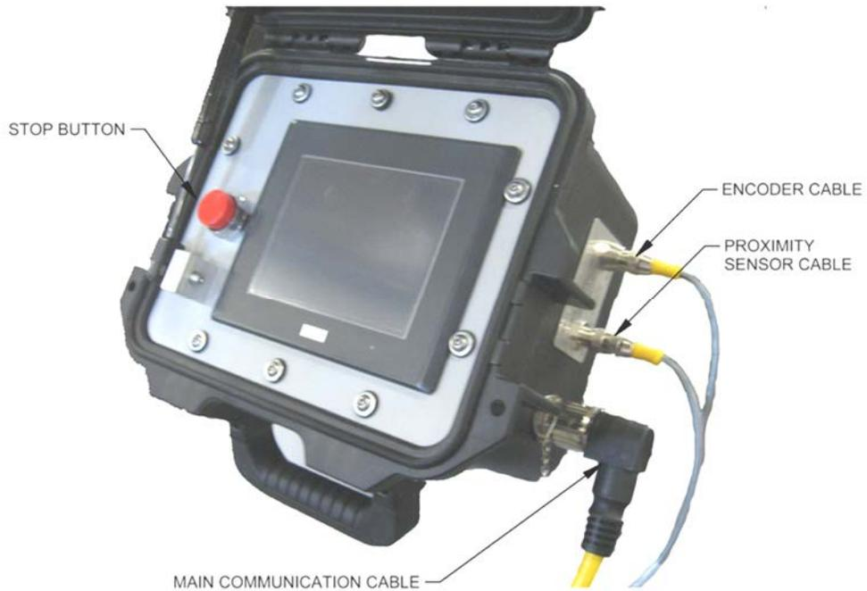
**Figura 51: Ensamble PLC**
