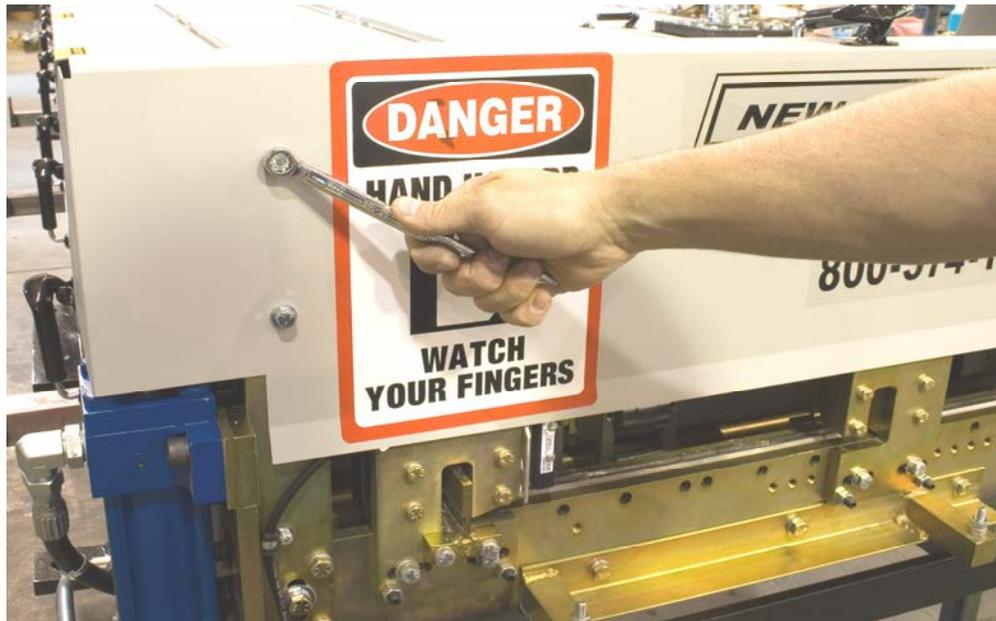
***Ilustración 59: Removiendo la Cubierta de Cizalla***
