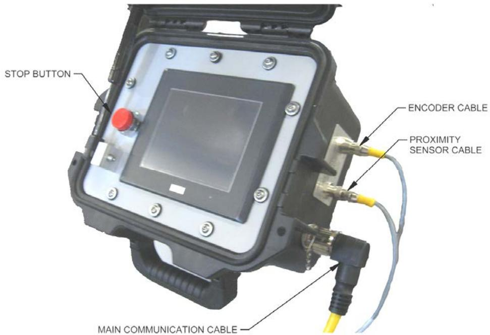
***Ilustración 101: Ensamble PLC***
