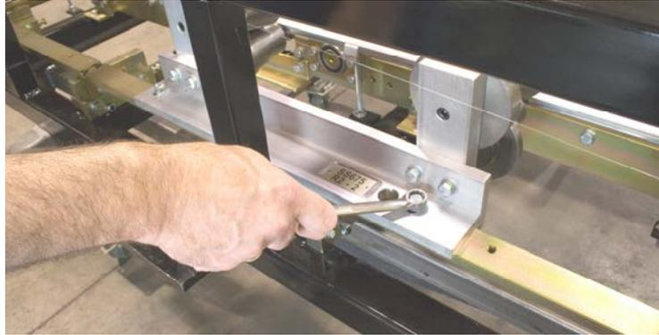
***Ilustración 41: Removiendo Carriles de Herramientas***
