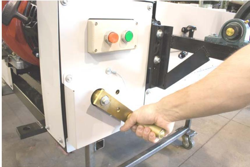
***Ilustración 53: Manija de Ajuste del Carril de Herramientas***
