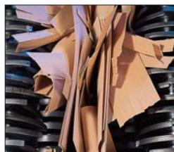
Alle Baureihen der RS30 und RS40 sind mit dem patentierten UNTHA-Vierwellen-Schneidsystem mit Lochgitter (Patent Nr. 319535) ausgestattet.
