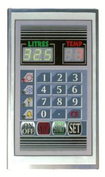
La zona neutra con funzione di miscelatore, ha la particolarità di mantenere l'acqua al valore di temperatura impostato; questo avviene tramite l'ausilio di una sonda elettronica, che controlla l'accensione del riscaldatore o del gruppo frigorifero, ottenendo così la funzione di miscelatore. La temperatura impostabile va da un valore di +1 a un valore di +35 gradi centigradi.
